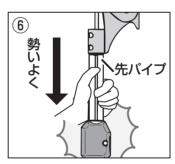
⑥先パイプを勢いよく押し 込みます。パチンと音が して、しっかり固定され ます。
