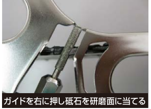
ガイドを右に押し砥石を研磨面に当てる
