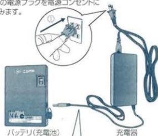
②バッテリー(充電電池)を充電器に接続します。(充電器のランプが赤に点灯します)
